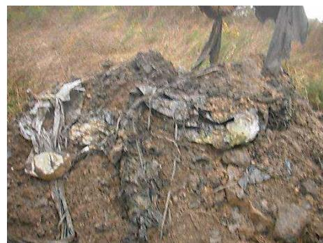
Les sondages ont mis en évidence différents types de terrains, leurs nature et caractéristiques mécaniques et notamment la Couche 0.R - Remblais de décharge -  $1 < Q_d < 24$  MPa.
